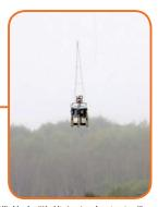
機体を墜落から守るテザー (紐)で係留気球に吊るし、ホ バリングや、約7mの上昇試 験を行いました。
