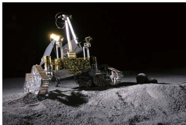
図2 JAXA月・惑星探査プログラムグループが開発を進める月面探査用ローバー
