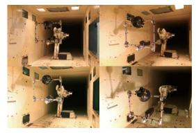
ダクテッドファン型飛行ロボットは低速時に、前後・左右・上昇下降と全方向に自由に飛行できるため、気流に対して様々な角度を取ります。そこで、 $-90 \sim +90$  度までの広い迎角で計測を行いました。
