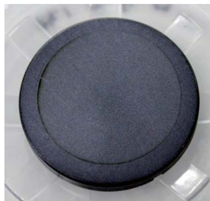
図2 JEMで宇宙曝露実験を行った固体潤滑剤
