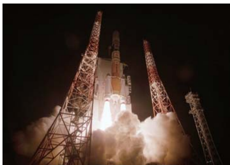
a H-IIAロケット 轟音を響かせながら高く昇ってゆくH-IIAロケット。打上げ用ロケットは化学推進系の代表です。
