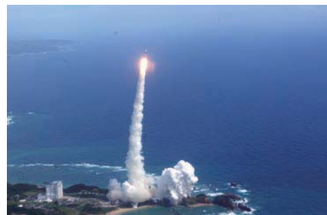
液体水素と液体酸素を混ぜ合わせて燃焼することで得られるエネルギーで宇宙空間まで飛んでゆく。
