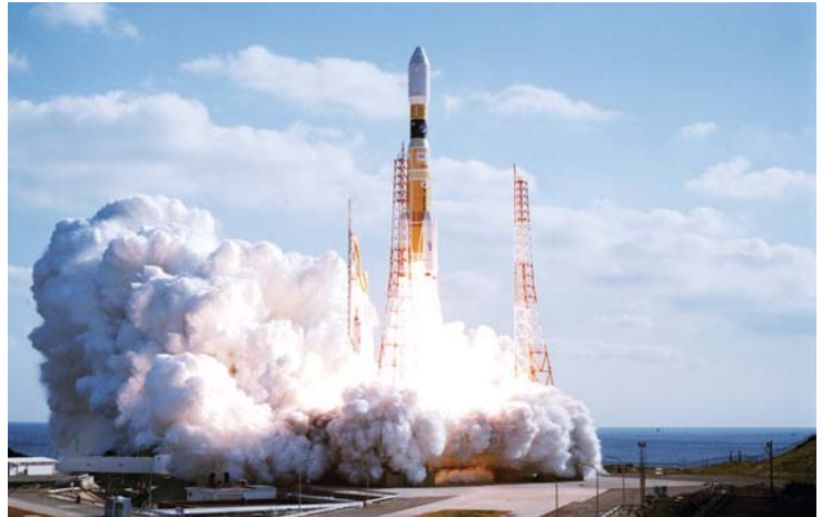
ロケットの先端、フェアリング内には人工衛星などの“荷物”が収納されている。
