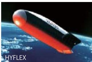
マッハ5以上の極超音速飛行時に揚力を得るための技術の実証と、発生した揚力を使って飛行する技術の実証を目的に1996年に行った
