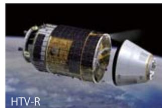
ISSへの物資補給機として、JAXAは宇宙ステーション補給機「こうのとりのり」を運用しているのだが、この「こうのとりのり」に物資回収機能を付加した機体としてHTV-Rの研究を進めている
