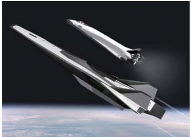
機体は途中で分離し、二段目は搭載しているロケットエンジンを使って宇宙まで飛び立ちます。一段目は翼に発生する揚力を利用して方向を変換し、次の飛行に備えて出発した基地へと戻ってゆきます。
